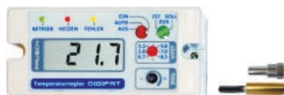
55015 **DIGIFAT** elektronischer Temperaturregler mit großer Digitalanzeige für Soll- und Istwert, einstellbarer Hysterese (besonders gut für Wärmepumpen geeignet), jede Temperatur ist getrennt kalibrierbar. Gegen Aufpreis können auch beliebige Bereiche zwischen -30°C und 90°C geliefert werden. Hand-, Aus- und Automatikschalter. Standard Einstellbereich 20°C bis 40°C. Mit Tauchfühler, Tauchhülse.
