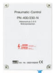
05591 **PN-230/400-N (0-8A)** kompakte Steuerung mit stufenlosem, elektronischem Motorschutz (0 - 8 A) und einstellbarer Laufzeitbegrenzung (0 - 25 min). Wahlweise 1- oder 3-phasig verwendbar. (3020100200)
