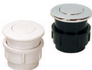
29355 **PN-Taster**, mit Kontermutter, Sichtteil chrom Blende: D = 49 mm; Einbaubohrung: D = 38,5 mm
