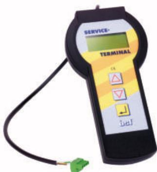
05320 **OSF-Service Terminal** Handgerät für Kundendienst und Montage. Einmalige Anschaffung. Für alle Steuerungen mit Diagnosestecker. Mit dem Service-Terminal kann eine Diagnose der Steuerungen durchgeführt, Betriebszustände abgefragt, Parameter programmiert und Zähler ausgelesen werden. (3010000900)
