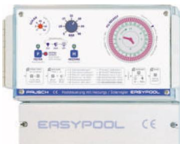
55062 **SOLPOOL-400 Solarfiltersteuerung** mit Drehknöpfen zum Einstellen der gewünschten Maximal- und Differenztemperatur. Mit intelligentem Motorschutz 0,7 A bis 7,5 A. **mit 2 Temperaturfühlern und Tauchhülse 1/2"**
