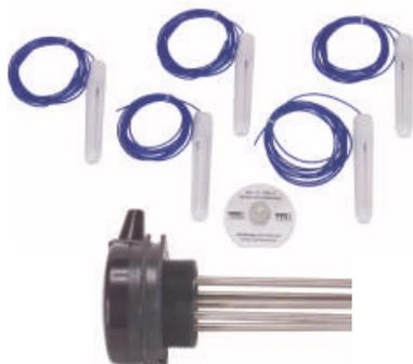
05435 **Elektrodensatz 5-fach OSF zu NR-12-TRS-2** 5 Elektroden mit KS-Schutzhülse und Halterung für Behälterverschraubung. Die Elektrodenleitung ist 3,0 m lang, Wasser- und ozonbeständig, VDE-geprüft (3030000012)
