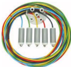
55141 **NIVCLUST** für Überlaufsteuerungen wie z.B. NIVPOOL. Kann anstelle von Stabelektroden für alle Schwallwassersteuerungen verwendet werden. Das Set beinhaltet 5 Hängeelektroden mit je 5 m farbkodiertem Spezialkabel für einen einfachen Anschluss und eine Fixiereinheit mit 5 getrennten Kabelverschraubungen. Kürzere Ausführung für niedrige Behälter.
