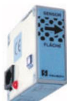
55146 **NIVCAP** Kapazitive Sonde misst berührungslos durch jede nicht leitende Gefäßwand bis ca. 30 mm Wandstärke. Justierbare Empfindlichkeit und Zustandsanzeige. Anschluss mittels praktischem Modularstecker. Kompakte Bauform 44 x 53 x 18 mm, inkl. 2 m Kabel mit Stecker. Für NIVA, LWARN, TROL, NIVPOOL, TWINNIV, SPS. Mikroprozessorintelligenz.
