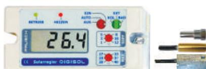
55001 **DIGISOL** Sonnenheizungsregler mit großer Digitalanzeige, einstellbarer Differenz- und Maximaltemperatur (20°C bis 40°C). Alle Hysteresen und Temperaturen sind getrennt kalibrierbar. Schalter für Hand-, Aus- und Automatikbetrieb.
