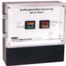
05433 **NR-12-TRS-2 Niveauregler** für Ausgleichsbecken mit Trockenlaufschutz und Zwangseinschaltung der Pumpe bei Überfüllung des Ausgleichsbeckens (3030000020)
